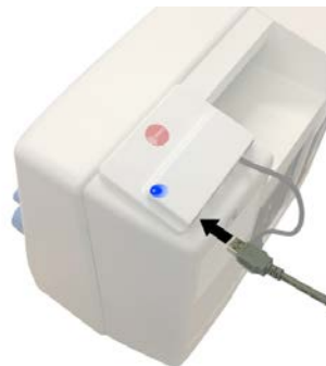
Slika 10.1.6. Priključitev pripomočka PhysioFlow Q-Link.
