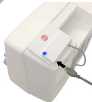
Slika 10.1.6. Spajanje uređaja PhysioFlow Q-Link.
