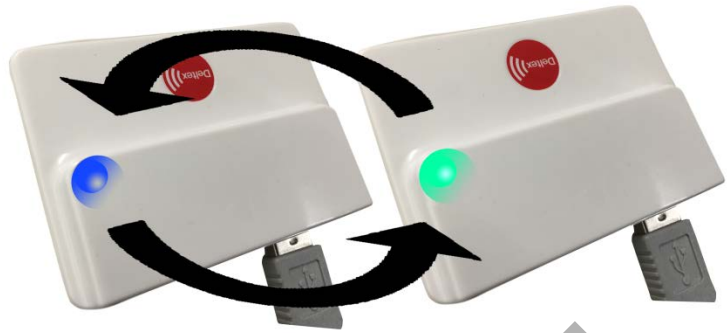
Figura 10.1.4. LED destellando del azul al verde.
