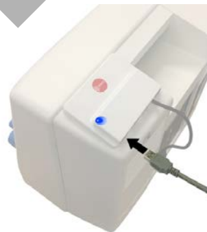
Figura 10.1.6. Conectando el Q-Link de HD-ICG.
